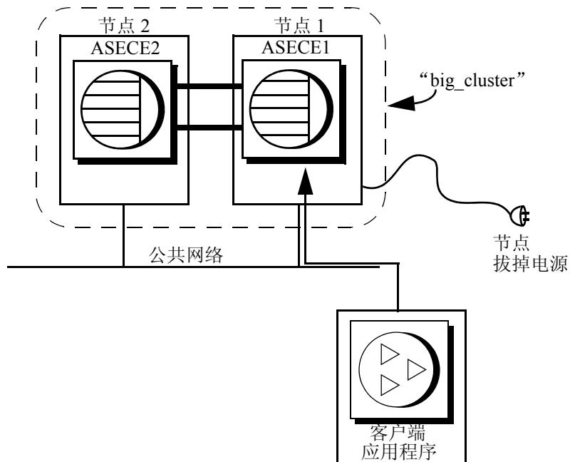
操作系统检测到崩溃，断开客户端的连接，将从连接的远程端对接口进行故障切换。
