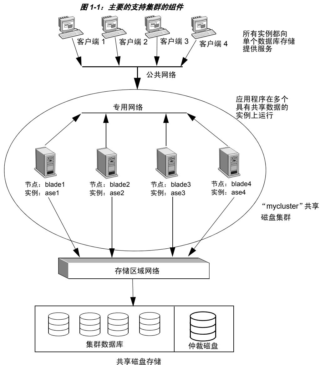
如果一个集群成员发生故障，其负载可以转移到未失败的集群成员上。例如，如果“ase1”发生故障，与该实例连接的客户端就可以通过故障切换功能切换到其余的任何处于活动状态的实例。请参见[第 5 页的图 1-2](#)。
