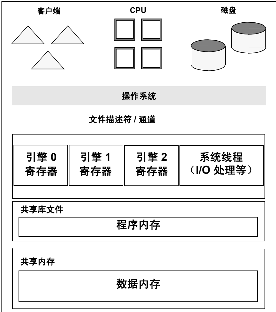
图 5-1：线程模式的体系结构
