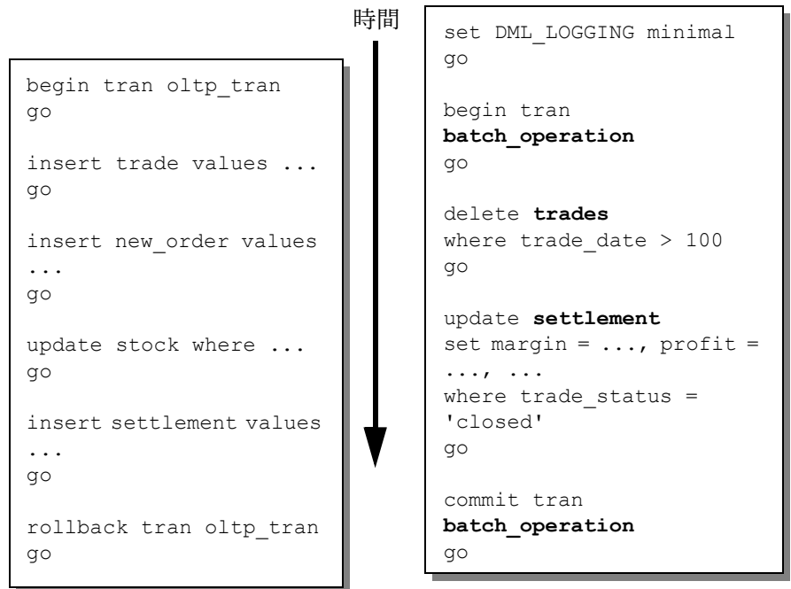
図 3-1: ロギング・モードの異なるトランザクションの同時実行
